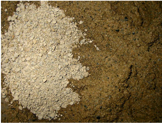
Figure 6: Vergleich des anstehenden Bodens vor und nach der Konditionierung mit Schaum und Polymer
