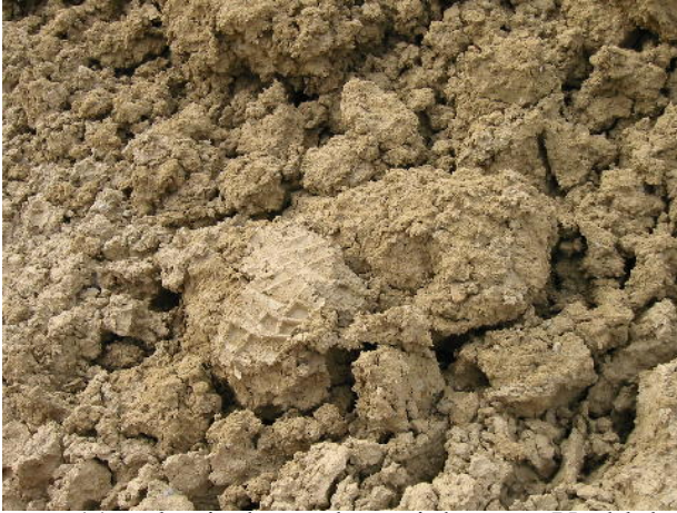
Figure 11: plastischer, aber nicht zur Verklebung neigender konditionierter Boden nach dem Abbau
