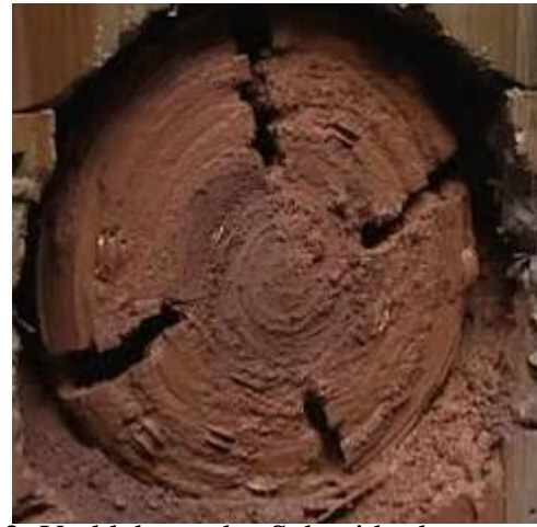
Figure 2: Verklebung des Schneidrades
