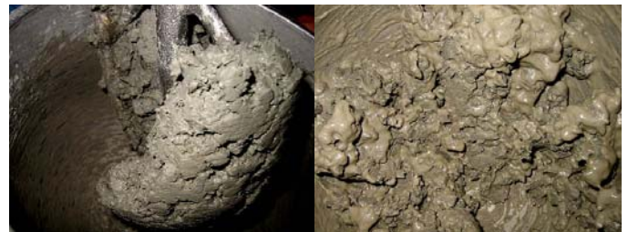
Figure 5: Verhalten nur mit Schaum und mit zusätzlichem Rheosoil® Anti-Ton-Additiv
