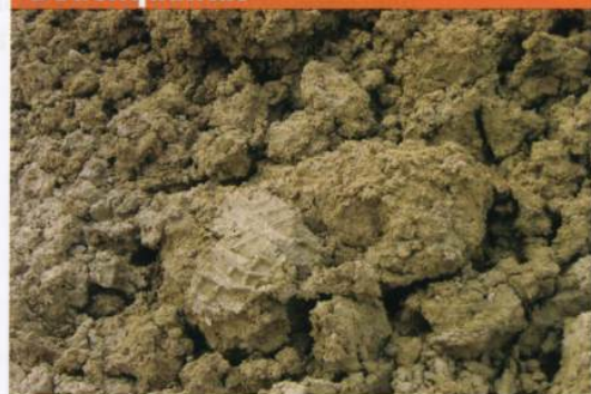
Bild 8. Plastischer, aber nicht zur Verklebung neigender konditionierter Boden nach dem Abbau.
