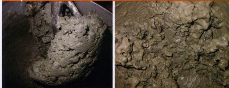
Bild 4. Verhalten nur mit Schaum und mit zusätzlichem Rheosoil® Anti-Ton-Additiv.
