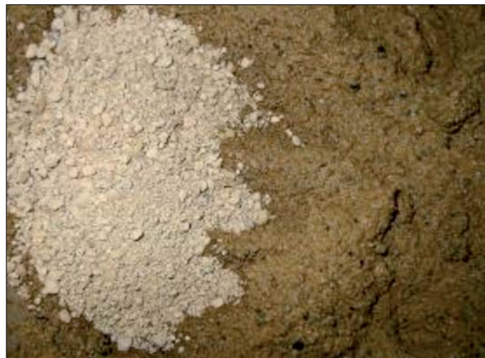
Obr. 6 Porovnání původní zcela suché pórovité zeminy a homogenní pasty ze zeminy po jejím smíchání s pěnou a polymerem
