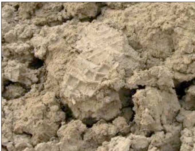
Obr. 11 Plastická ale nelepivá zemina po vytěžení Fig. 11 Plastic but not adhesive soil after excavation
