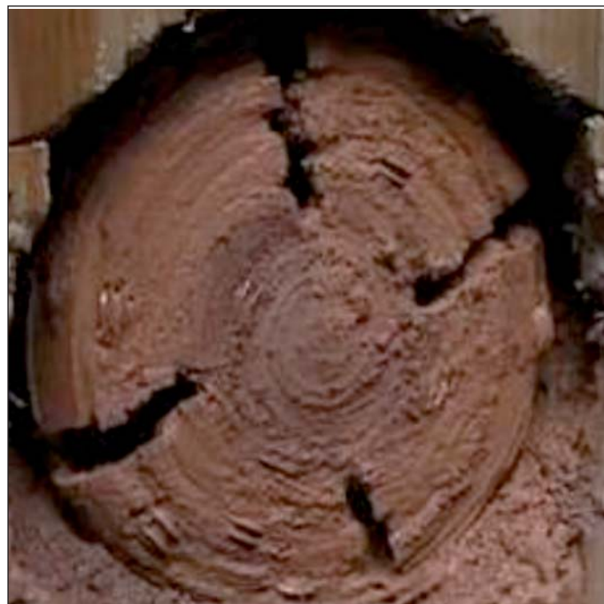
Obr. 2 Ucpání řezné hlavy tunelovacího stroje jílem Fig. 2 Clay clogging on the TBM cutterhead
