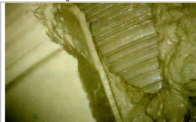
Bild 14: Verklebung am STBM-Schneidrad
