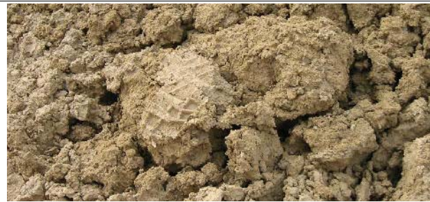
Bild 10: plastischer, aber nicht zur Verklebung neigender konditionierter Boden nach dem Abbau
