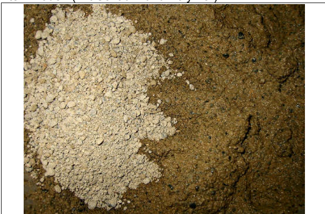
Bild 6: Vergleich des Original-Bodens mit konditioniertem Boden (mit Schaum und Polymer)
