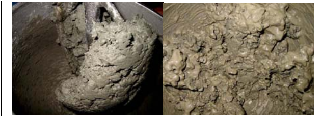
Bild 5: Verhalten eines tonigen Bodens nur mit Schaum und mit zusätzlichem Rheosol® Anti-Ton-Additiv
